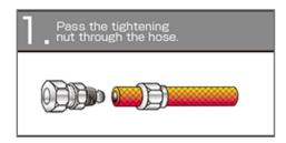
สวมตัวหัวครอบข้อต่อเข้าไปที่สายก่อน Pass the tightening nut through the hose.
